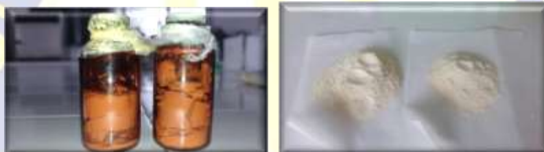
d. Polimer yang terbentuk setelah dimasukkan ke dalam oven e. Polimer setelah penggerusan dan pengayakan
