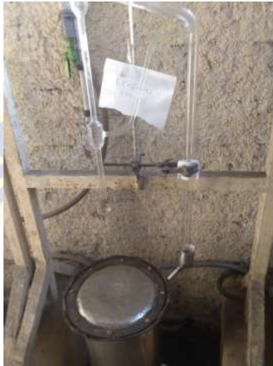
Gambar V.6 Proses penyulingan minyak atsiri dengan destilasi uap dan air
