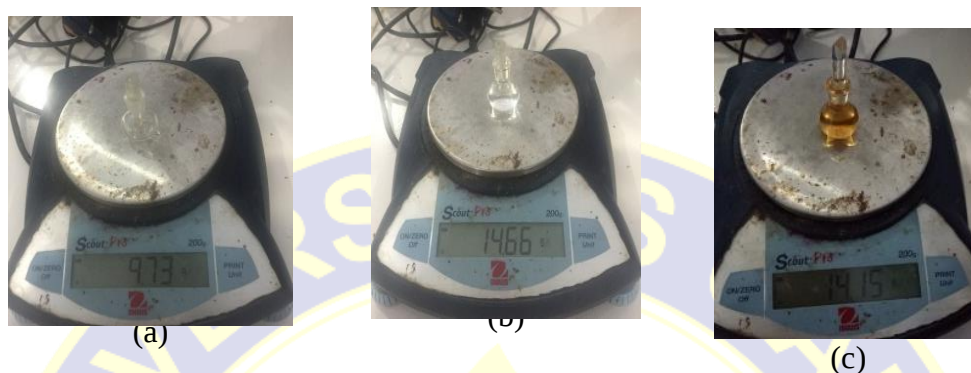
Gambar IV.7 (a) Pikno kosong (b) Pikno + air (c) Pikno + minyak atsiri
