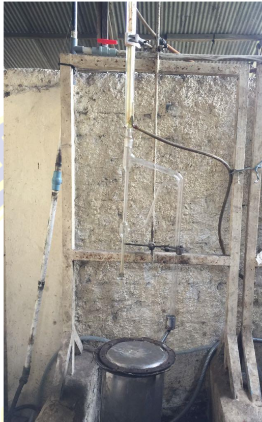
Gambar IV.4 Proses penyulingan minyak atsiri destilasi uap dan air
