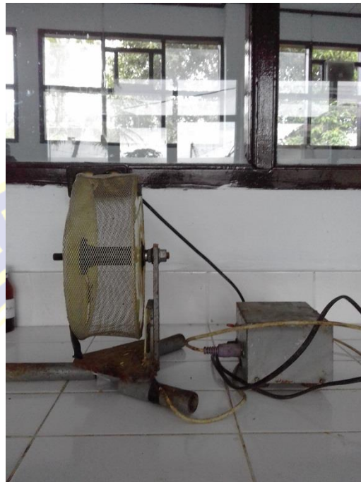
Gambar 4.9 Alat uji hipnotik-sedatif metode Wheel Cage (sangkar putar)
