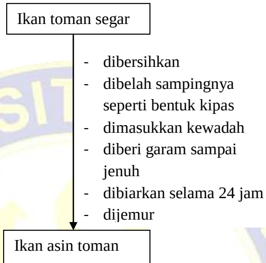
Gambar IV.2 Diagram alur simulasi ikan asin toman
