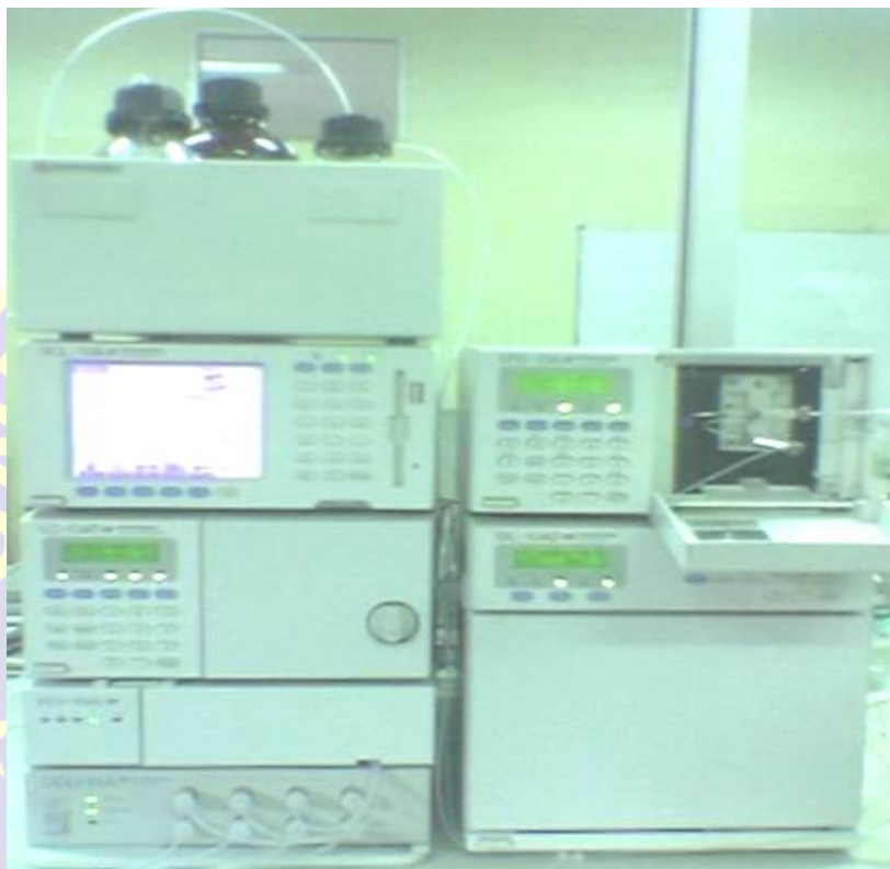
Gambar 2.4 Kromatografi Cair Kinerja Tinggi Shimadzu model LC-10A yang dilengkapi oleh detektor UV-VIS SPD-10AV di Laboratorium Penelitian UNPAD
