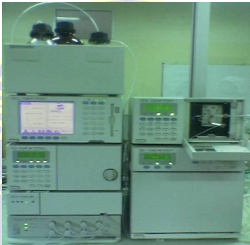
Gambar 9 Kromatografi Cair Kinerja Tinggi Shimadzu model LC-10A yang dilengkapi oleh detektor UV-VIS SPD-10AV di Lab Penelitian UNPAD
