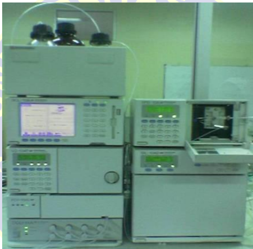
Gambar 8. Kromatografi Cair Kinerja Tinggi Shimadzu model LC-10A yang dilengkapi oleh detektor UV-VIS SPD-
