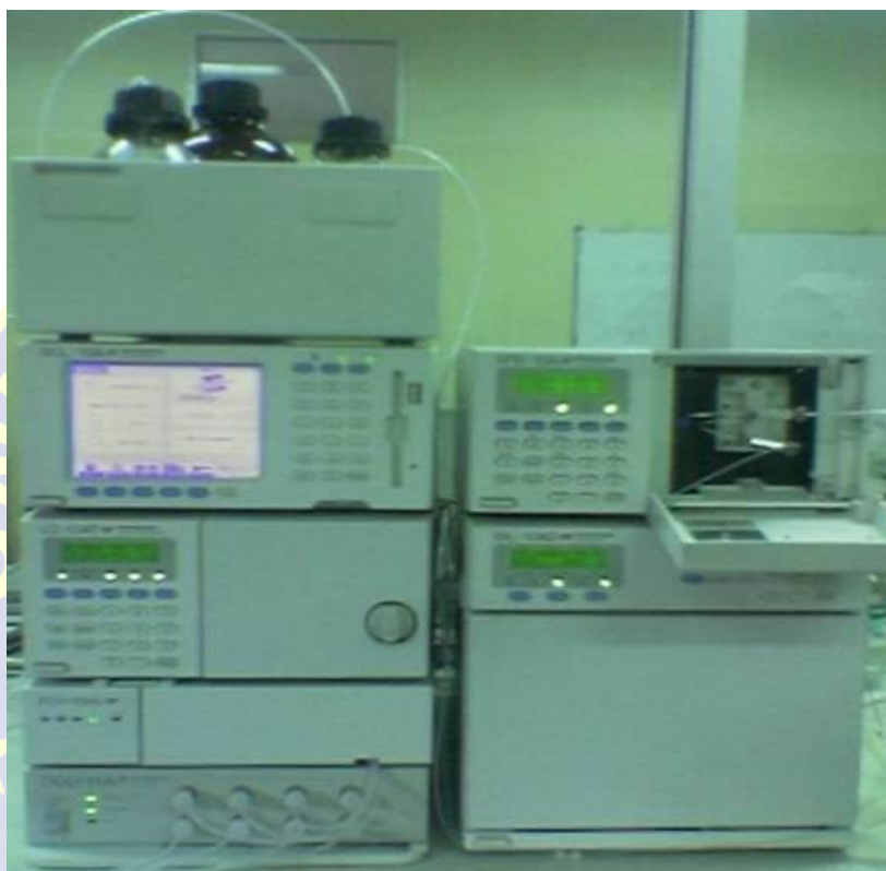
Gambar 8. Kromatografi Cair Kinerja Tinggi Shimadzu model LC-10A yang dilengkapi oleh detektor UV-VIS SPD-10AV di Lab Penelitian UNPAD
